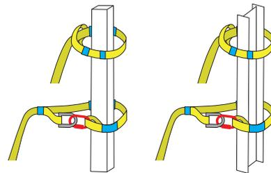
Suspendu ou par connecteur EN 362 sur poteaux ou poutres
