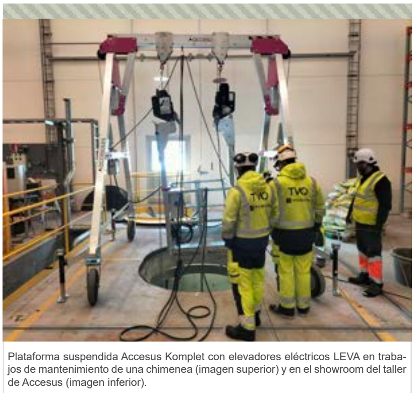
Elevador eléctrico LEVA en plataforma colgante Accesus Basic.
