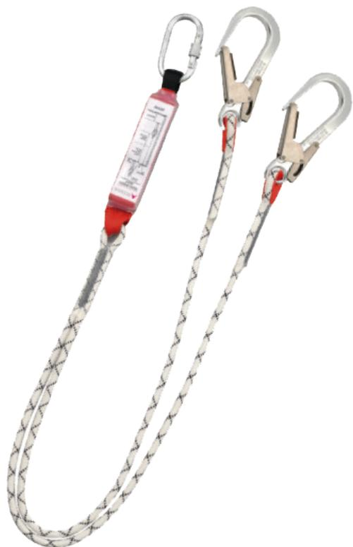
Longe en corde double avec absorbeur ABE-YY modèle 611414, fabriqué en polyamide avec 2 cosses et 2 connecteurs en acier AA023 (60 mm) à une extrémité, un absorbeur d'énergie et un connecteur en acier AA011 à l'autre extrémité. Diamètre de la corde de 10,5 mm et 2 m longueur.
