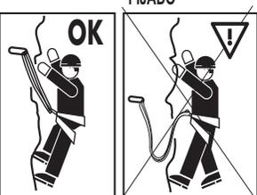
**EVITAR CAÍDAS CON EL CONECTOR FIJADO**
