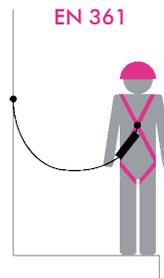
O arnês A03S está em conformidade com a norma EN 361 para dispositivos de paragem de queda (ponta de ancoragem dianteira e dorsal).
