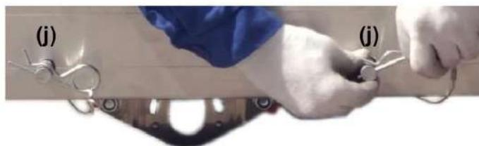
15- Después de la instalación de todos los carros necesarios, instale un segundo soporte en el extremo de la viga (k) usando el tornillo "A" (l). Asegure el tornillo con el pasador de chaveta (l1). En esta etapa es fácil de quitar el transportador de viga ASB500-600.
