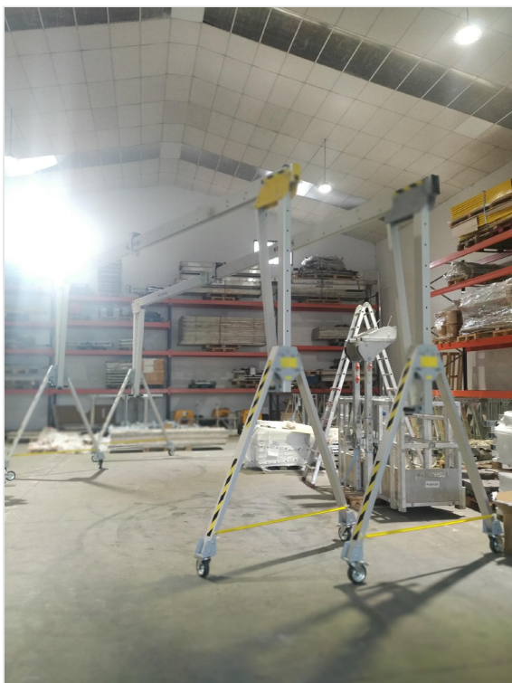
Montaje para realizar las pruebas de carga de unos pórticos modelo "PCP-A" de vigas de 7 y 9 m.
