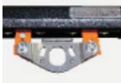
2 Puntos de anclaje móviles en la viga
